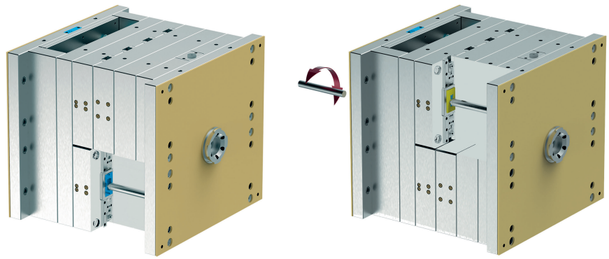
Kinematisch durchdacht: Spritzgießen der Komponente 1 (links) sowie Drehen des Werkzeugs in Position 2 und Spritzgießen der Komponente 2 (rechts) © Strack Norma
